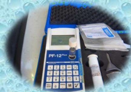
Fotômetro – Medição de Turbidez in Loco
